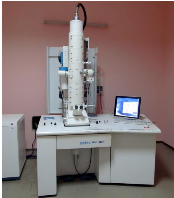
Рисунок 2.3 - Зовнішній вигляд просвічуючого електронного мікроскопу ПЕМ-125 К: 1 - станина приладу; 2 - колона; 3 - камера спостереження і реєстрації; 4 - вакуумна система; 5 - високовольтний генератор; 6 - блок живлення лінз; 7 - комп'ютер
